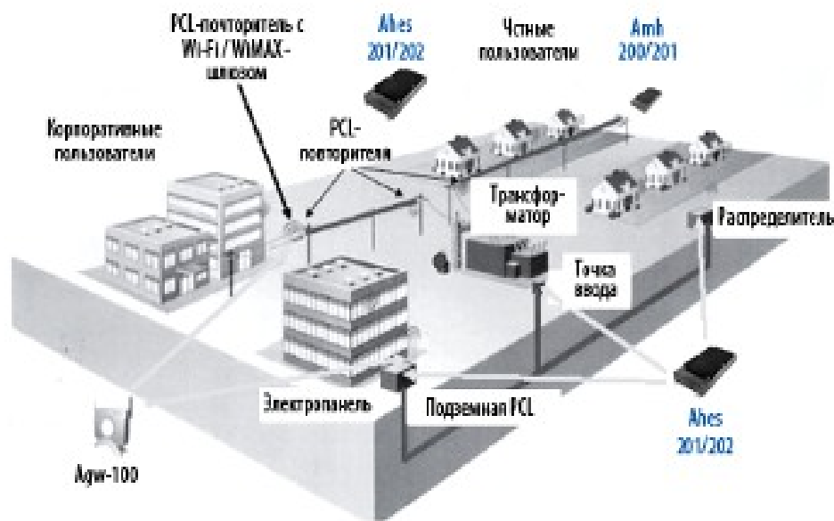
Рис 1. Схема підключення корпоративних користувачів до Інтернету за технологією PLC
