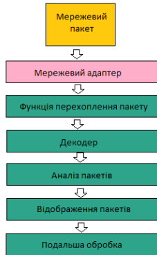
Рис. 1 Принцип роботи пакетного сніффера
