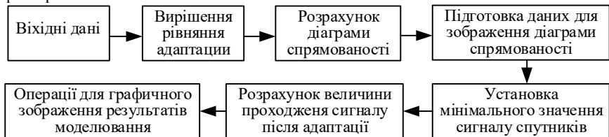
Рис.2. Блок-схема програми для моделювання придушення спуфінгу.
