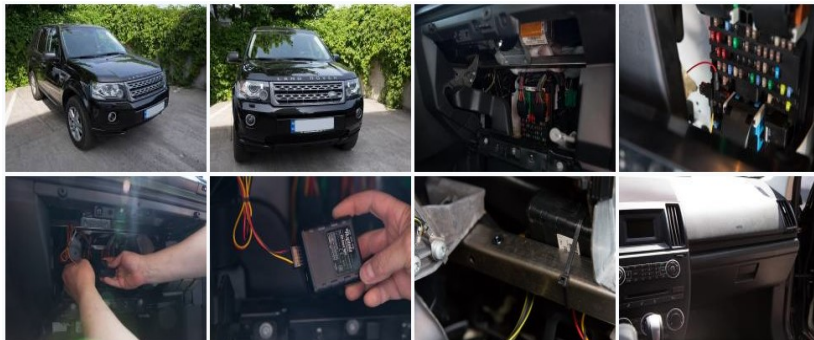
Рисунок 2. Фото встановлення GPS трекера на автомобіль
