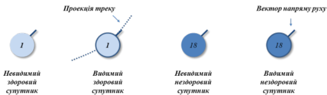
Рисунок 2 – Символьні позначення супутників на головному вікні
