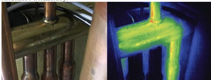
Рис 2. Тепловізійна фотографія, зроблена під час діагностики несправних клапанів
