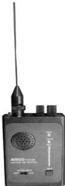
Рис. 4.12 Детектор поля RFC-61
