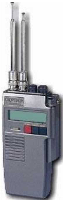
Рис. 4.13 Приймач ближньої зони "СКОРПІОН 2"
