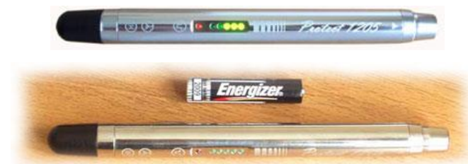
Рис. 4.16 Індикатор поля Protect 1205
