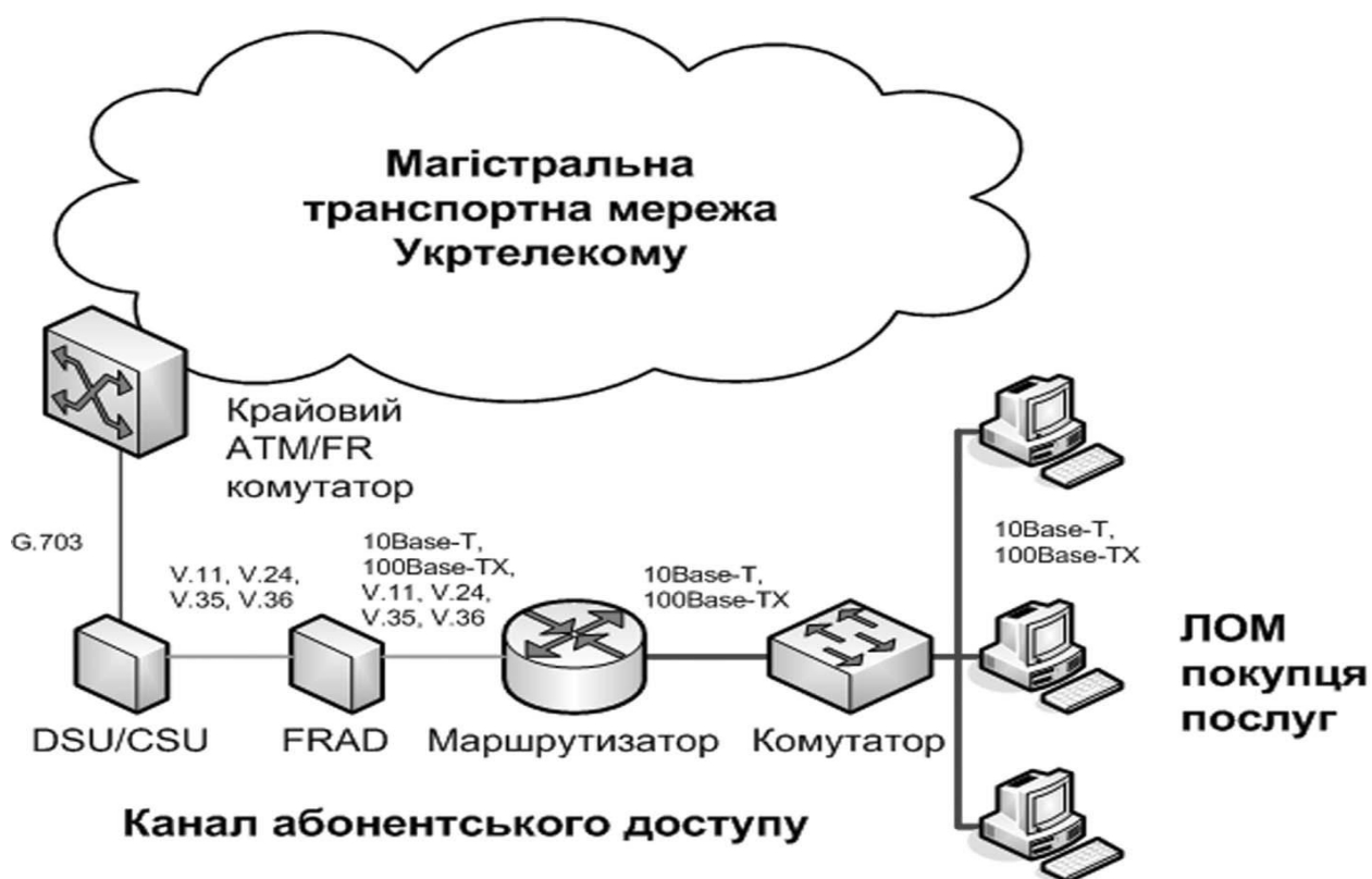
Рисунок 6.1 – Підключення локальної мережі до магістральної транспортної мережі
